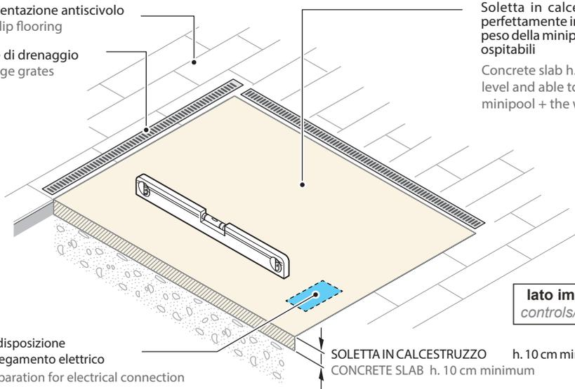
Soletta in calcestruzzo h. 10 cm minimo, perfettamente in bolla e adatta a sostenere il peso della minipiscina + il peso delle persone ospitabili
