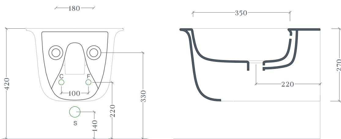
N.B. Le misure indicate possono subire una variazione dell 0,6% circa, dovuta ad usura stampi e a variazioni delle caratteristiche tecniche relative alle materie prime che compongono l'impasto .
