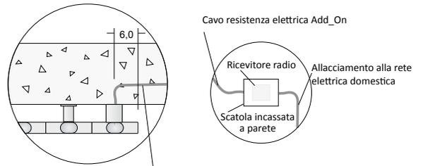
cavo di alimentazione della resistenza elettrica o di allacciamento del ricevitore wireless da inserire in una scatola incassata a muro posizionata a piacimento fino a 1,20 cm dall'Add\_On
