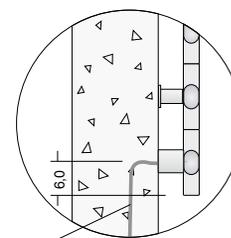
cavo di alimentazione della resistenza elettrica o di allacciamento del ricevitore wireless da inserire in una scatola incassata a muro posizionata a piacimento fino a 1,20 cm dall'Add\_On
