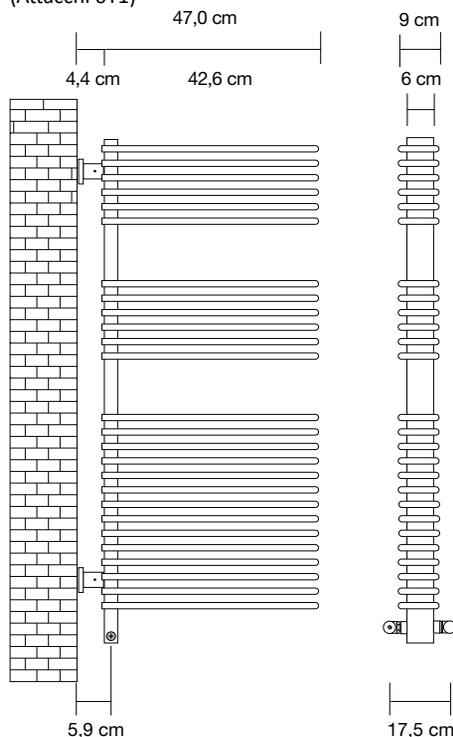
Interasse attacchi con misure riferite alle valvole Tubes
