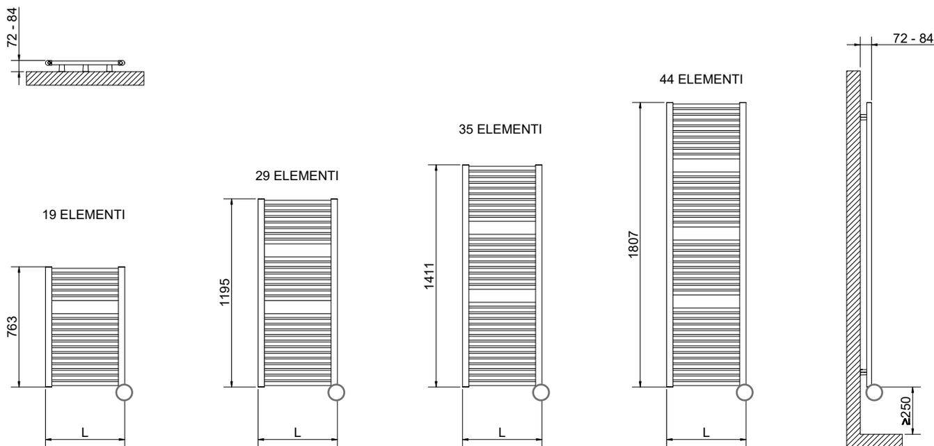
○ L'ingombro complessivo del radiatore in altezza va calcolato considerando l'altezza del termostato
